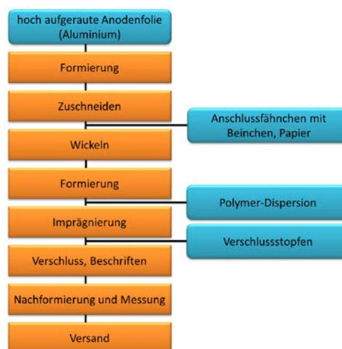
Abb. 6: Herstellprozess von Polymer Aluminium Elektrolytkondensatoren
