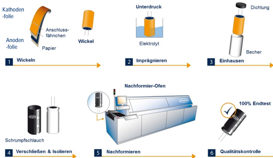
Abb. 3: Prozessschritte vom Vormaterial zum Elko
