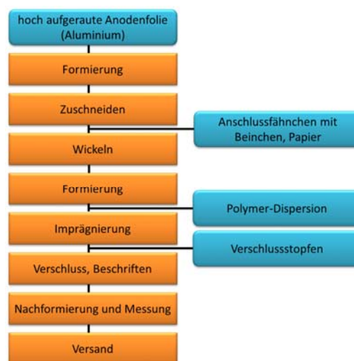
Abb. 6: Herstellprozess von Polymer Aluminium Elektrolytkondensatoren
