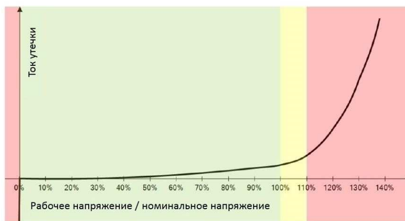
Рис. 4. Типовая зависимость тока утечки от отношения рабочего и номинального напряжения для конденсатора высокого напряжения
