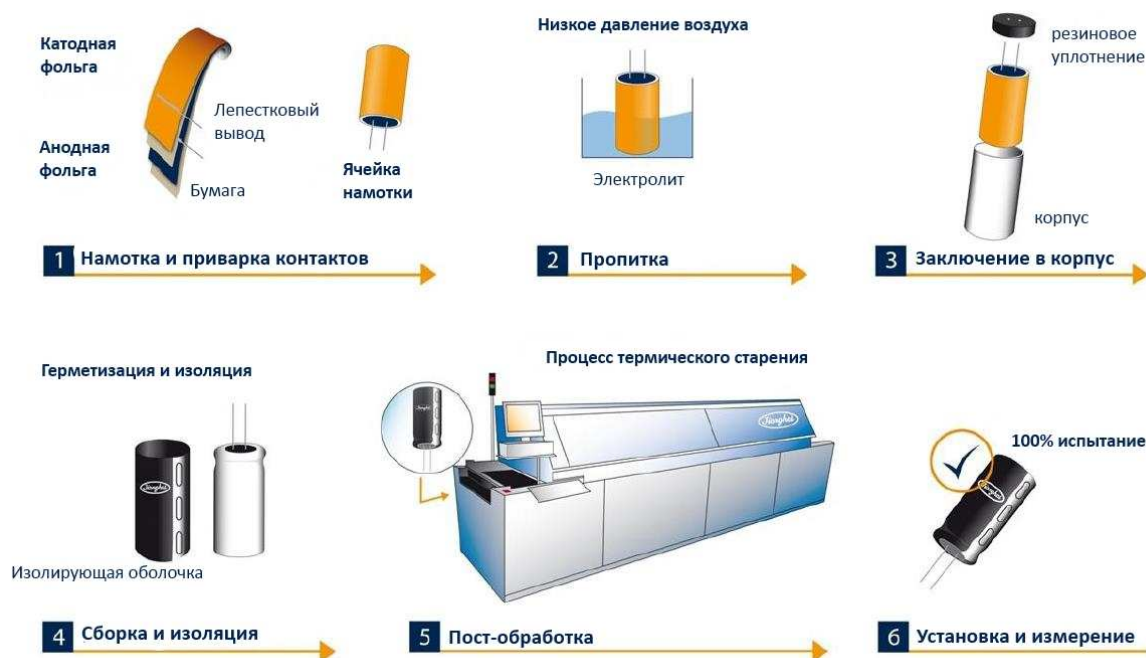
Рис. 3. Технологические шаги от сырья до конденсатора
