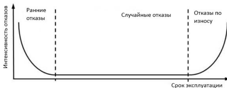
Рис. 3. Зависимость интенсивности отказов от времени - U-образная кривая
