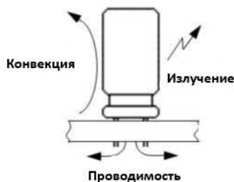
Рис. 4. Механизмы охлаждения электролитических конденсаторов
